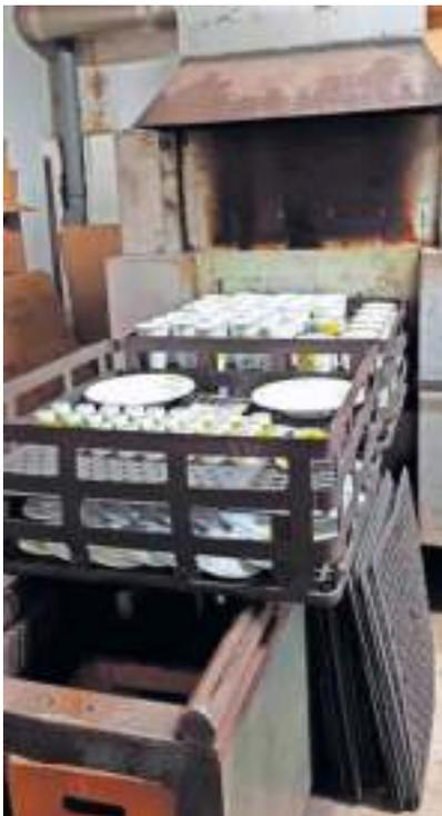
Als Eintunnel-Durchgangsofen (Fabr.Nr. E80422) mit 28 Schmelzkörben aus schwerem, hochhitzebeständigem Chromnickelstahl und meiner Länge von 16,5 Metern war meine Bedienung oft kräftezehrend, da besagte Metallkörbe permanent von Hand aneinander gekoppelt werden mussten, um den Kreislauf beim Brennvorgang aufrecht zu erhalten. Ein Brennvorgang bei Porzellan dauerte ca. drei Stunden, mit Glas gefüllt nur 1,5 Stunden.
